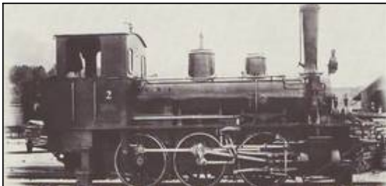
Dampflok Ed 3/3 Nummer 2. Eine Dreikupppler Lokomotive der SEB (Foto: Archiv BLS)
